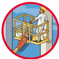
**La PEMP est un engin de levage, pas un moyen d'accès**
